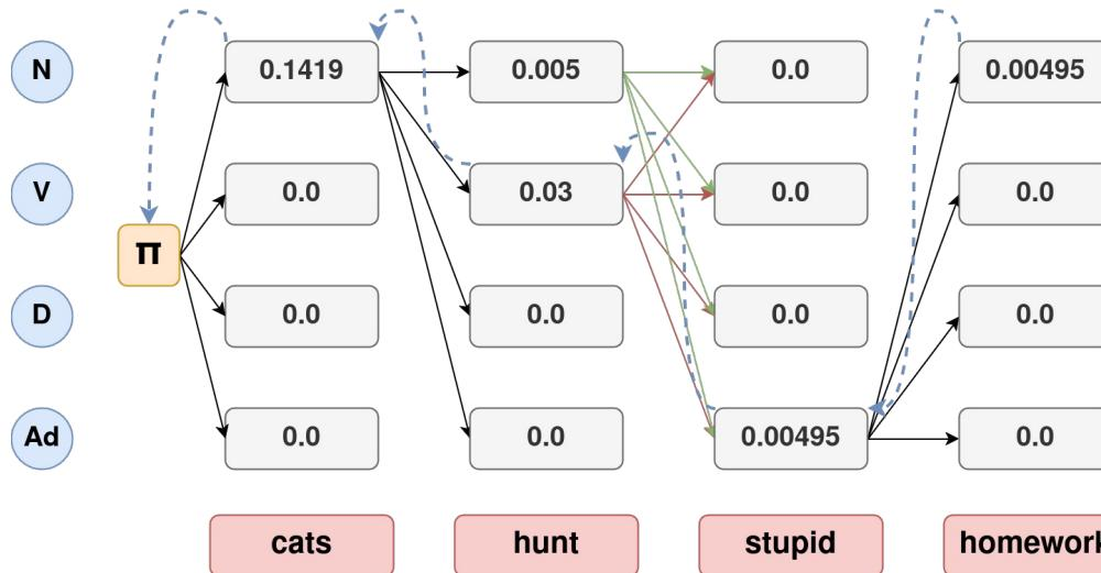
Zuletzt: Backtracing des optimalen Pfades ( $N \rightarrow Ad \rightarrow V \rightarrow N$  für „N V Ad N“)
